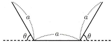
流れる水が最大  $\rightarrow$  といの断面積が最大
